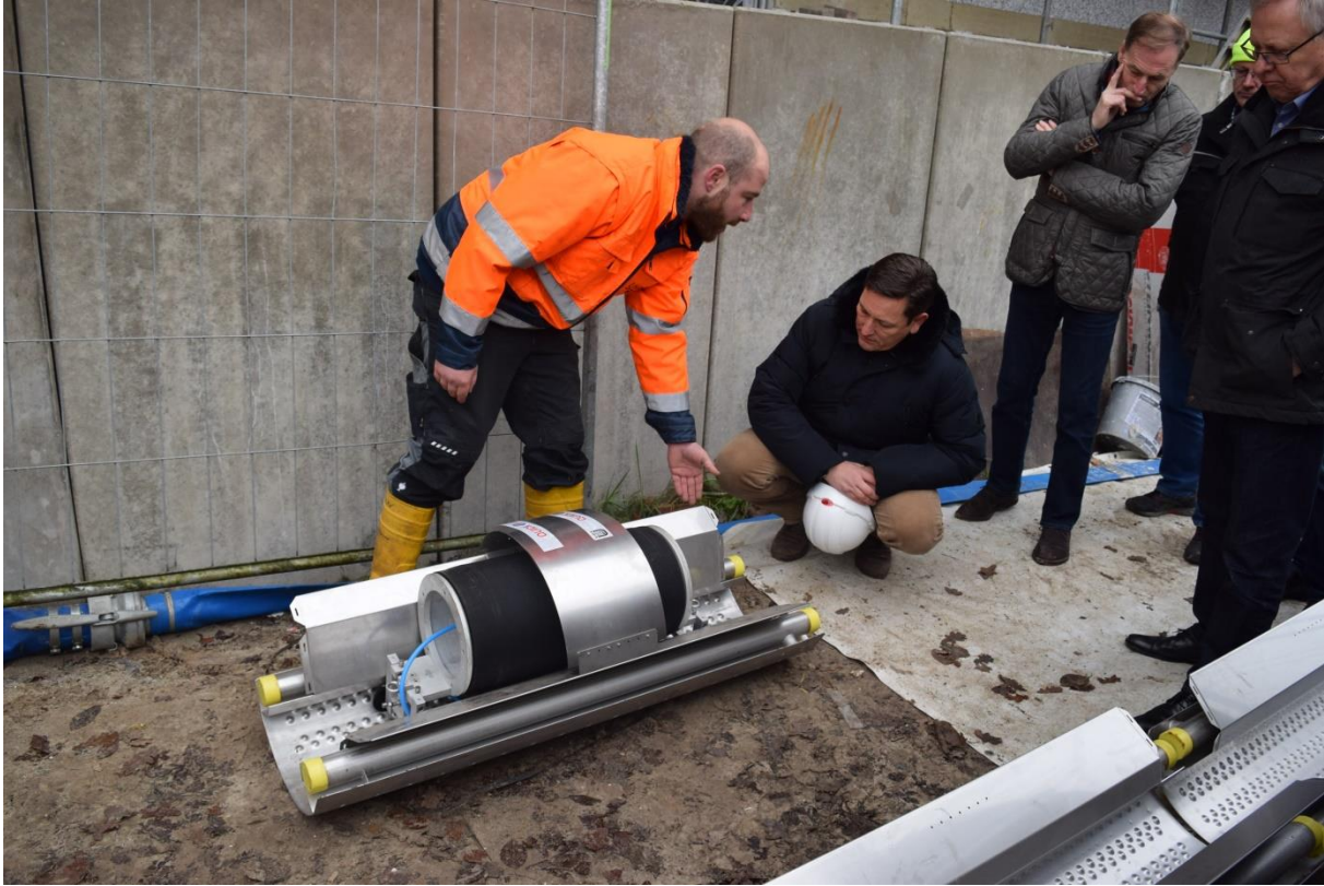
Abbildung 2: Abwasserwärmeüberträger (©Stadt Oldenburg)
